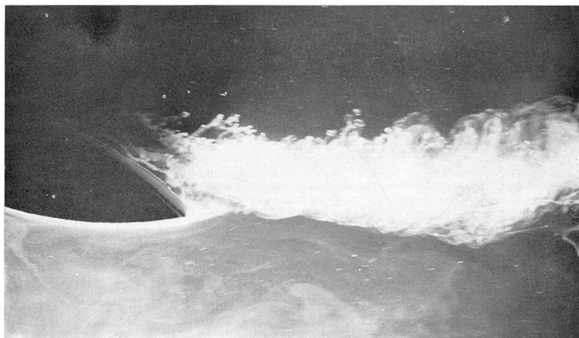
写真 7 R 型模型船の剝離渦 右 20 度斜航, R=4500
