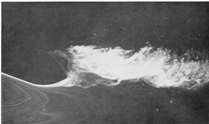
写真 10 R 型模型船の剥離渦 右 20 度斜航, R = 4500
