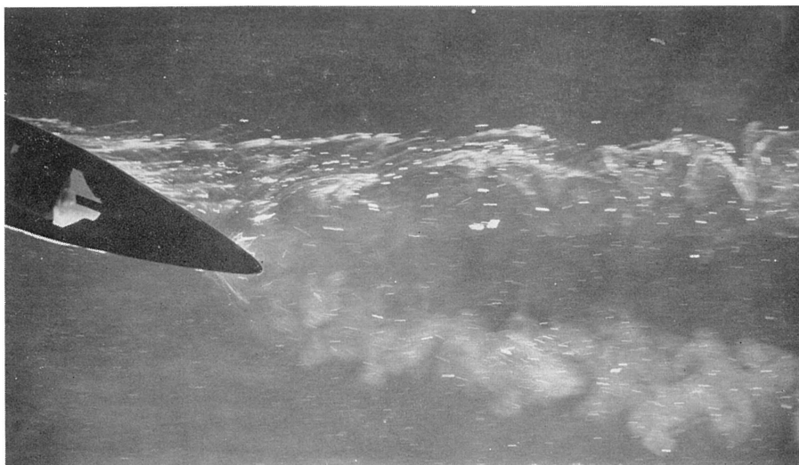
写真 15 戦艦M模型船が斜航する場合の剝離渦とプロペラ後流 右 20 度斜航, R=7000 , プロペラ回転数 11 r. p. s. .
