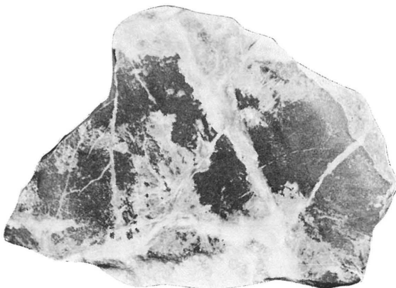
第9図 初成ブラウン鉱(黒色)とそれを交代する後期生のテフロ石(灰色)およびそれを切る方解石(白色脈状)×1.5
