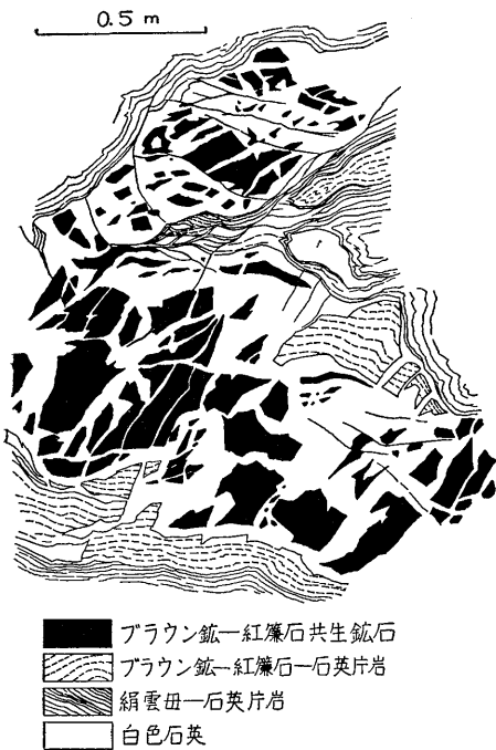
第 7 図 成寿鉱山本坑東部の角礫質鉱体スケッチ
