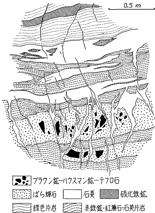
第2図 上須戒鉱山3号坑口の硫化鉄鉱床(上盤)とマンガン鉱床(下盤)
