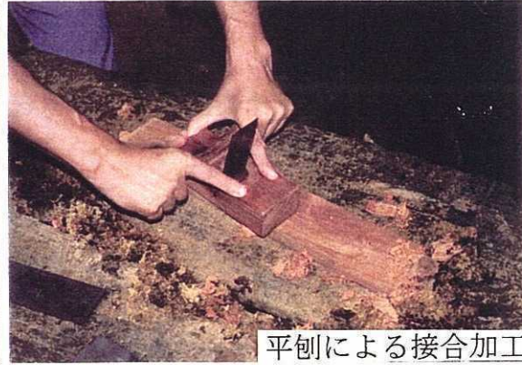
図 2-10 蘇州紅木彫刻廠の蜈蚣鉋と蟻鉋， 框架鋸と平刨による接合加工
