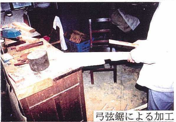
図 2-10 蘇州紅木彫刻廠の蜈蚣鉋と蟻鉋， 框架鋸と平刨による接合加工
