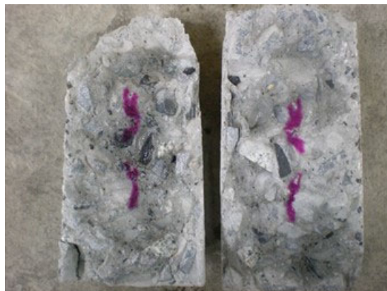
写真 6.4-8 境界ブロックとともに排気ガス養生したテストピースの炭酸化 14 日 における炭酸化状況
