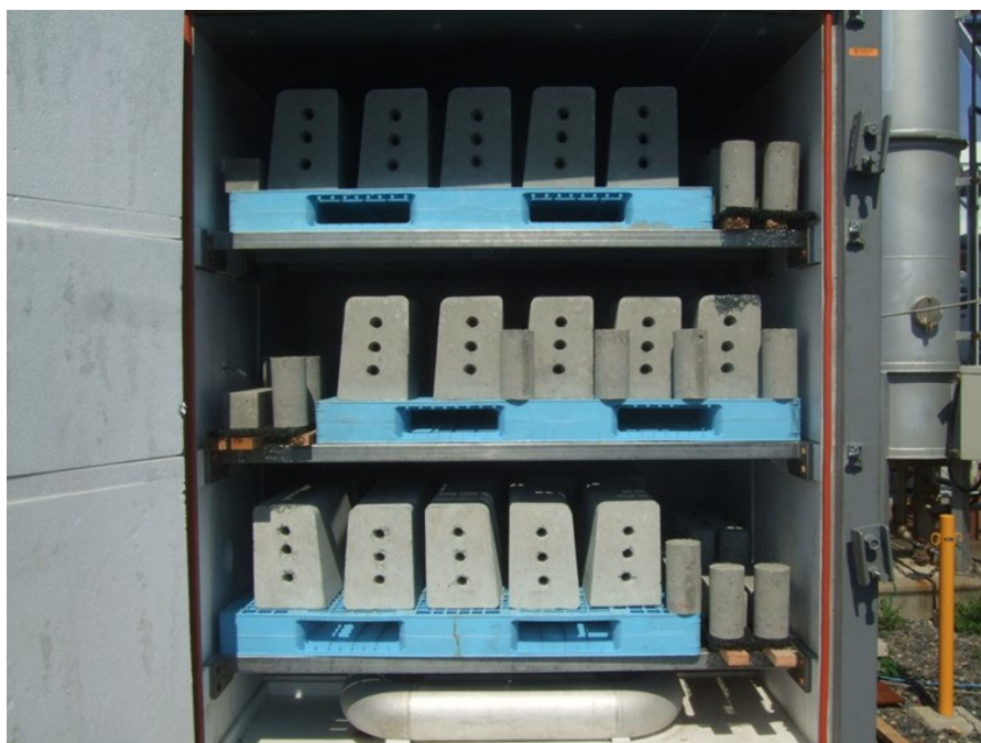
写真 6.4-5 コンクリートブロックの炭酸化養生状況
