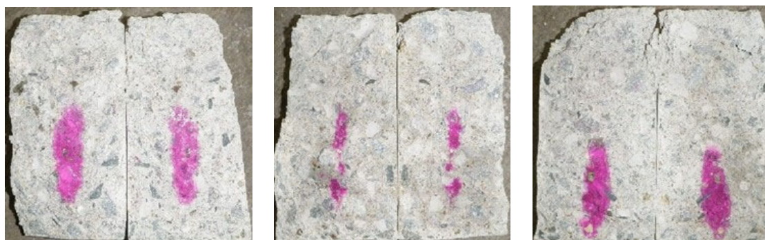
写真 6.2-7 排気ガス養生（第 1 回）における材齢 40 日の炭酸化深さ
