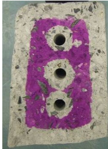
写真 6.4-7 排気ガス養生した境界ブロックの炭酸化 14 日における炭酸化状況
