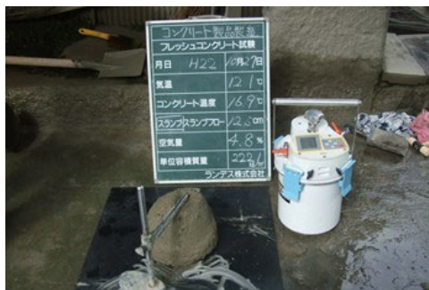
写真 6.2-2 コンクリートのフレッシュ性状
