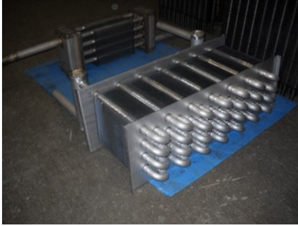
写真 6.3-1 工業用水用クーラー部（左）および蒸気用ヒーター部（右）の配管
