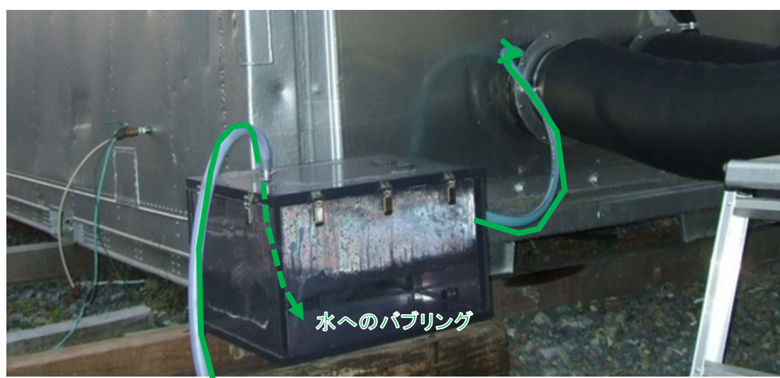
写真 6.2-6 SO x 除去装置の概要
