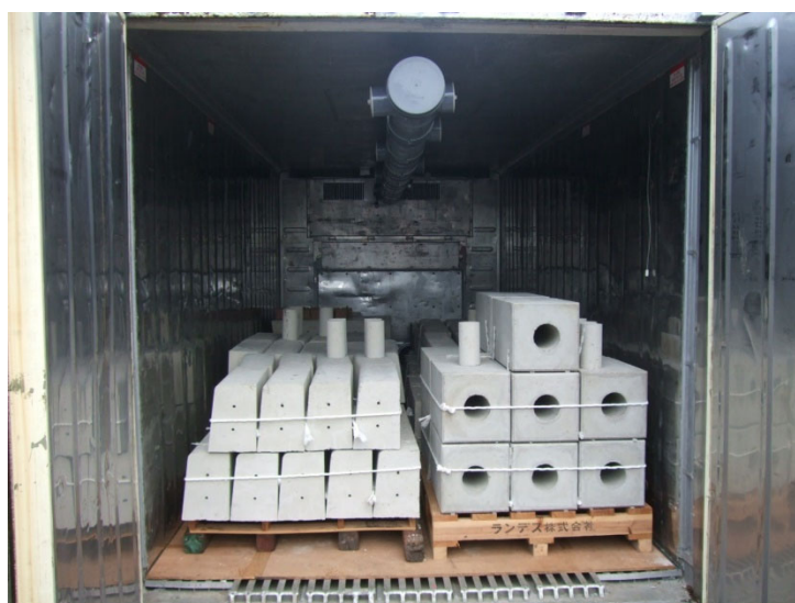
写真 6.2-4 炭酸化養生コンテナ内部の状況
