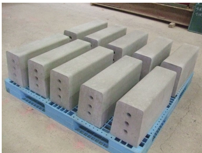
図 6.4-4 製品養生状況と製造完了後の製品の外観
