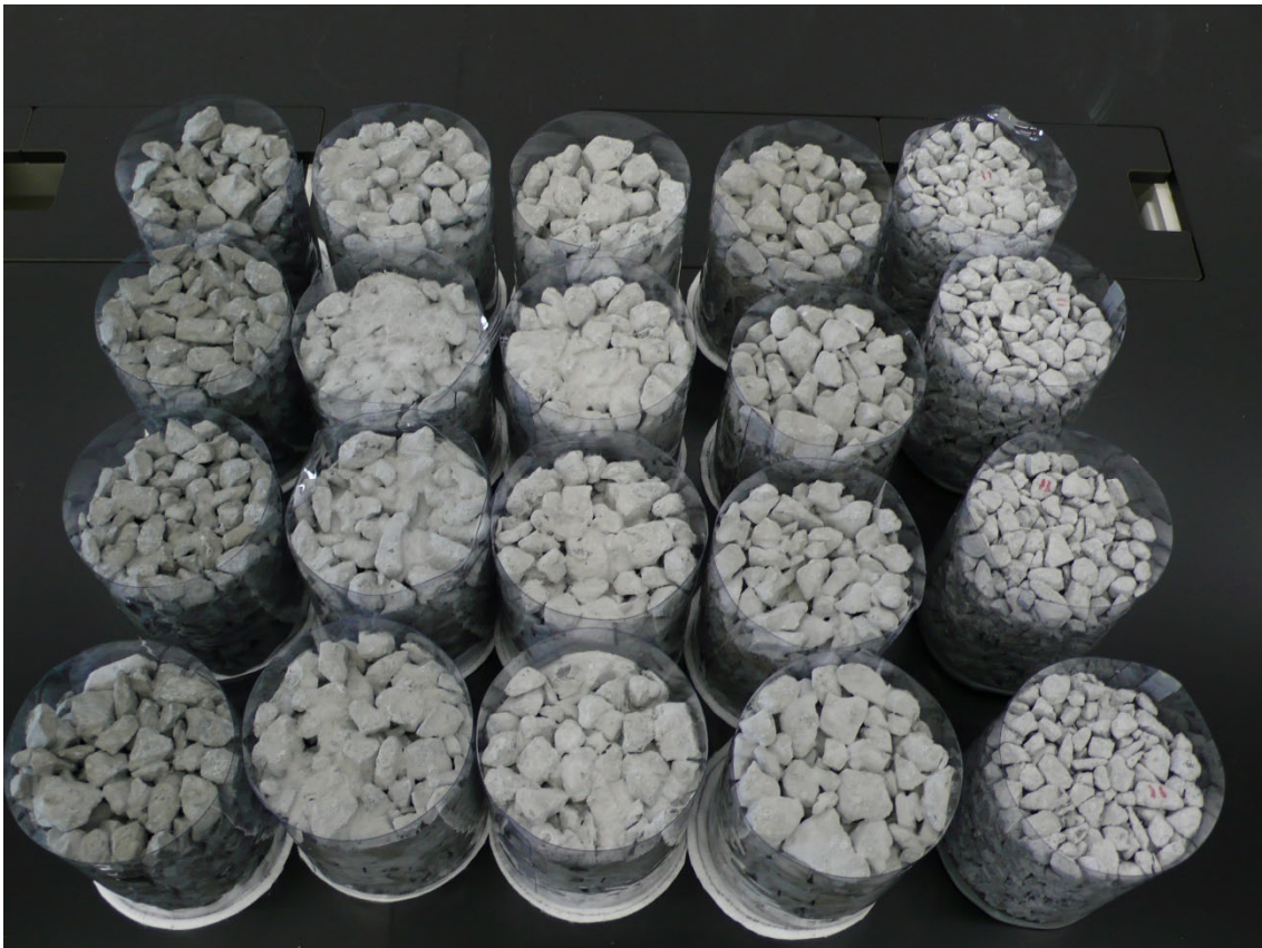
写真 5.4-2 植物生育試験に用いたポーラスコンクリート円柱供試体
