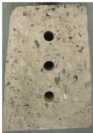
写真 6.4-9 材齢 47 日まで排気ガス養生した境界ブロックの炭酸化状況
