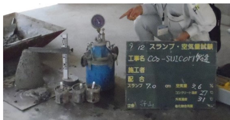
写真 3.4-1 コンクリートのフレッシュ性状
