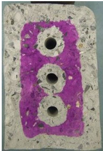
写真 6.4-7 排気ガス養生した境界ブロックの炭酸化 14 日における炭酸化状況
