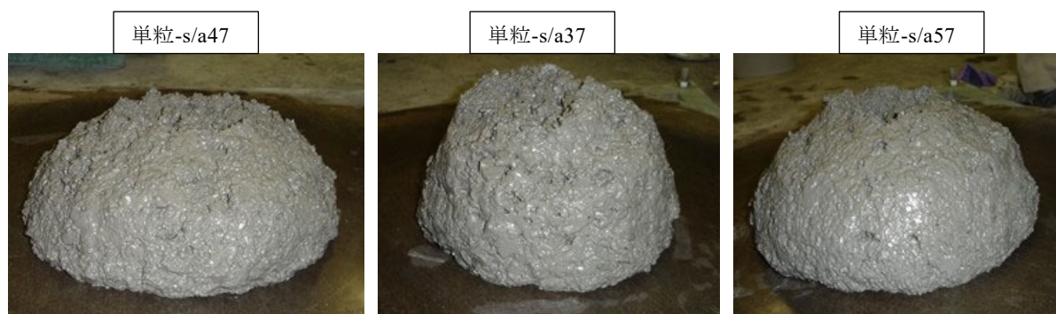
写真 4.2-2 単粒度の細骨材を用いたコンクリートのフレッシュ性状
