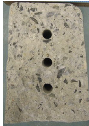
写真 6.4-9 材齢 47 日まで排気ガス養生した境界ブロックの炭酸化状況
