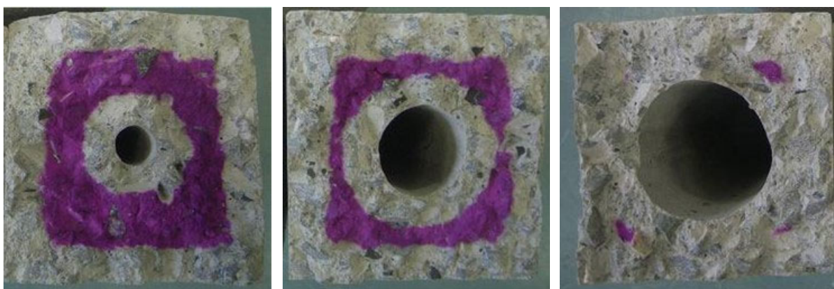
写真 6.4-4 角柱供試体内部からの炭酸化状況 (左から \phi 24\text{mm} 、 \phi 52\text{mm} 、 \phi 75\text{mm} )
