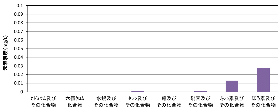
図 5.3-4 微量成分溶出試験結果
