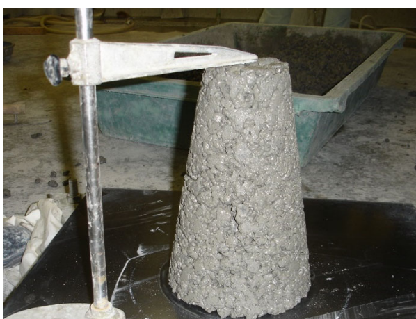
写真 4.2-3 W/P=30%、単位水量=117kg/m 3 のコンクリートの外観 (スランプは計測不可、VC=7.6 秒)
