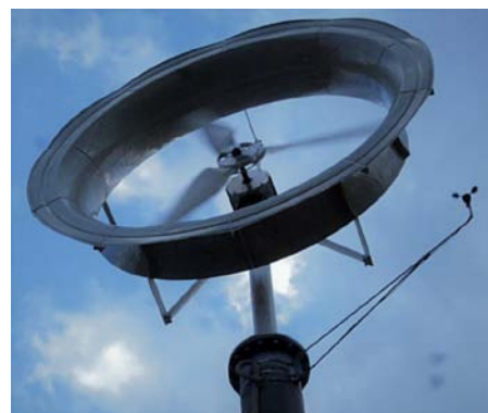
図 1 風車用つば付きディフューザ
