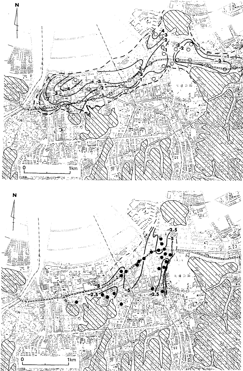
第7図 箱崎砂層の下底面の等深度線図（上図）と奈多砂層の上限の等深度線図（下図）
