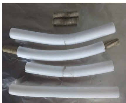
図2 ロゴスキーコイル試作部品
