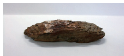
写真-1 多くの錆に見られる層状の構造
