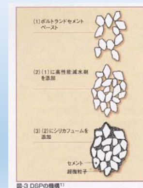
図-3 DSPの機構 1)
