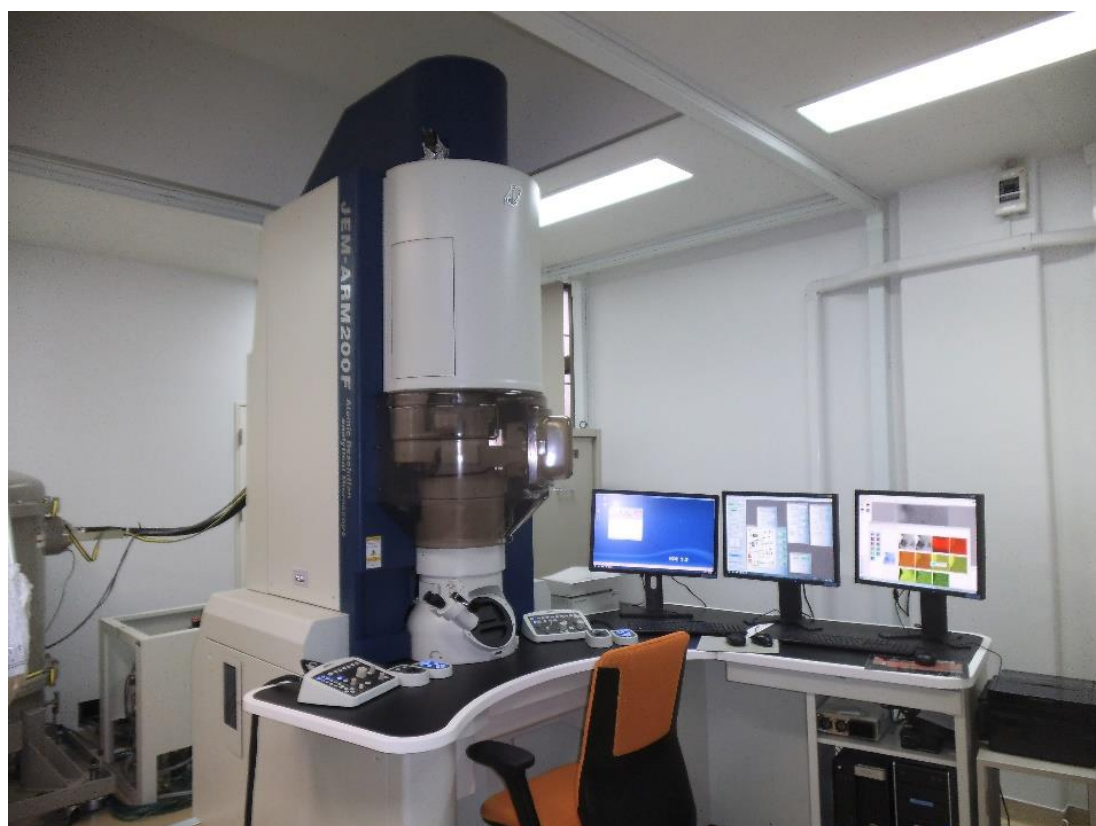
図 2-4 使用した収差補正機能付き走査透過型電子顕微鏡（ARM）
