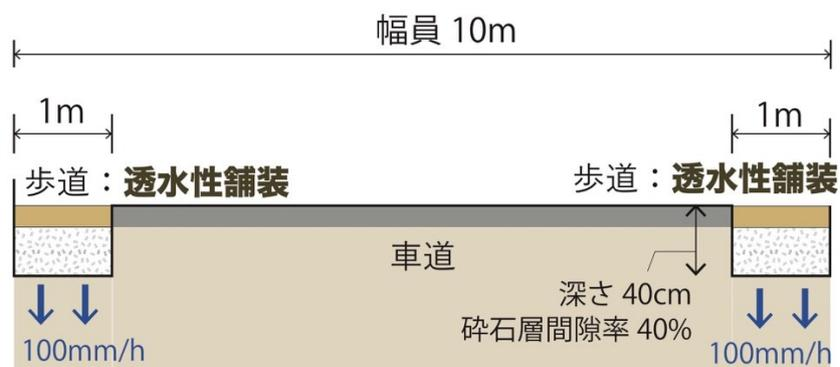
図 2-11 2車線道路への導入モデルイメージ (断面図)
