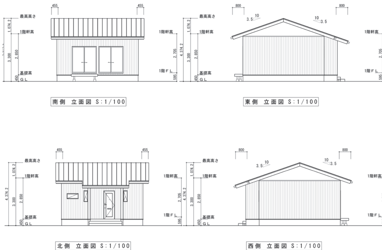
図 1-3. 木造仮設住宅の立面図 (2DK) S=1:100 注5)
