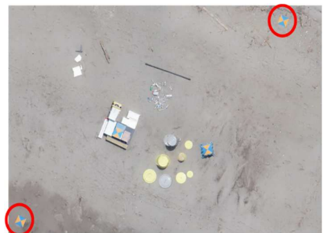
図1 ドローン空撮から得られた海岸画像。赤丸は対空標識を示す。地上画素寸法は5mm(上空17mから撮影)。
