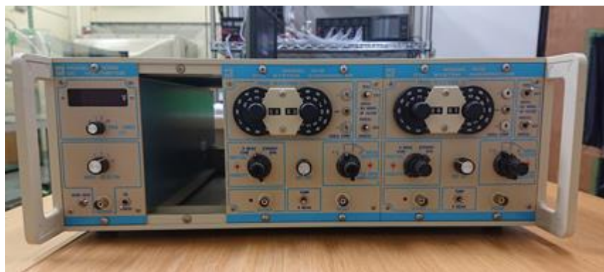
図 2.16 CTA ユニット (アンプ)
