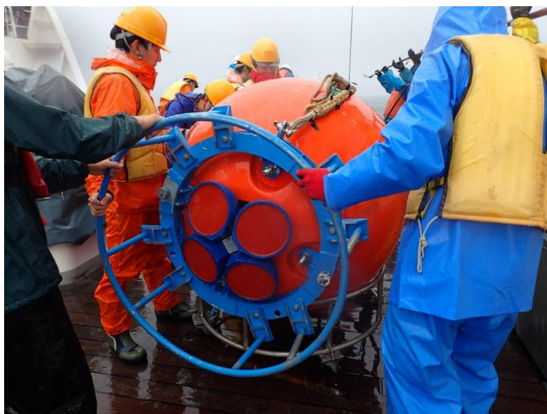
Fig.2-2 ADCP の係留の概念図(a)と ADCP を投入する様子(b)
