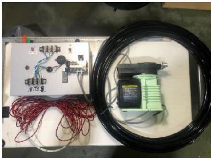
Figure3.4.2 漏水検知装置
