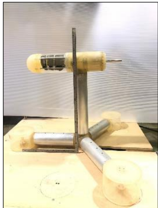
Figure3.2.39 ナセル本体、支柱、脚部 全体図
