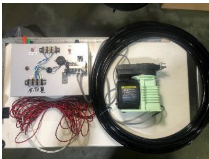
Figure3.4.2 漏水検知装置
