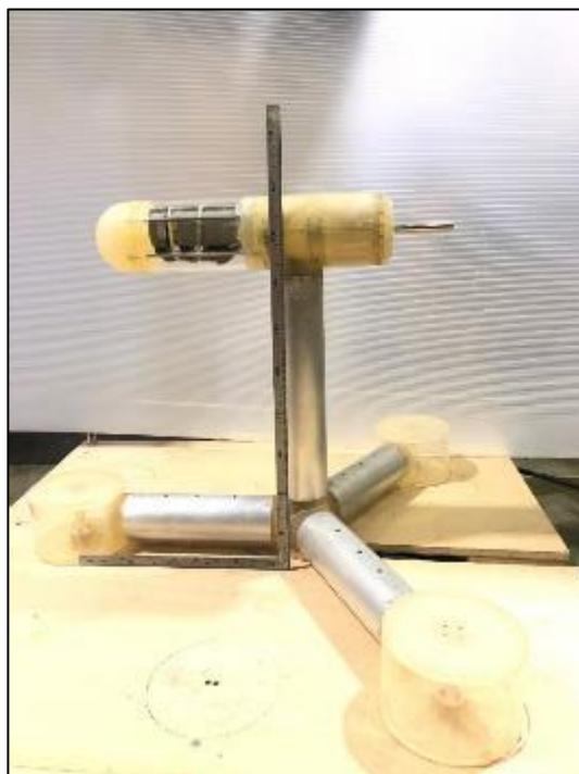
Figure3.2.39 ナセル本体、支柱、脚部 全体図
