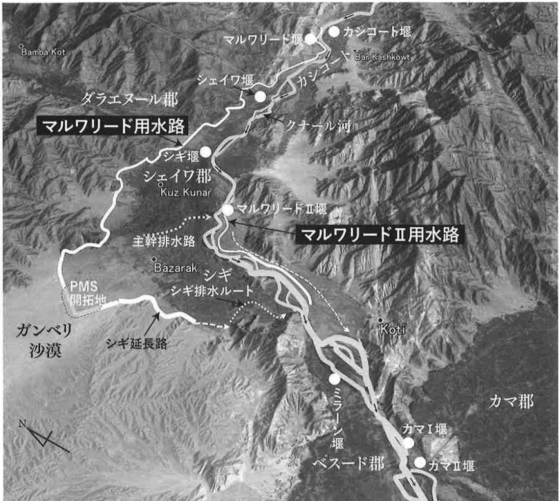
2003年からPMSはクナール河20km流域に8カ所の取水堰を建設している
