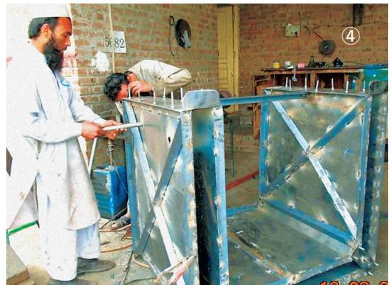
U字溝のモールド（型枠）や連結式ブロックは、PMSワークショップ（在ガンベリ農場）で作成する。①～③は連結式ブロック作成過程。④はU字溝のモールド作成
