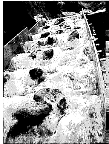
図2 捨て石型魚道実験魚道（10段）の流況。
