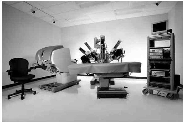
図1 手術支援ロボット da Vinci (Intuitive Surgical, Inc., CA, USA) 左から Surgeon Console, Surgical Cart, Vision Cart, 術者は Surgeon Console に座り, 3次元映像を見ながら Surgical Cart を操作する.
