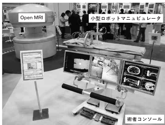
図 3 MRI 環境下で動作可能な小型手術支援ロボット 術者はあらゆる術前・術中の情報を統合して手術する。 HOSPEX JAPAN 2005 (2005 年 11 月 東京ビッグサイト) にて展示された。
