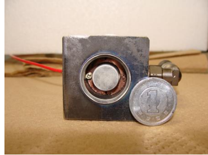
図 2-3 低電力シリンドリカルホールスラスタ: A) 概略図 B) 写真 10)
