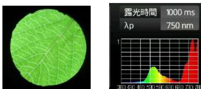
(図 60)15 時での自然光を透過したアジサイの葉(左) (図 61)15 時での自然光を透過したアジサイの葉の分光分布図(右)
