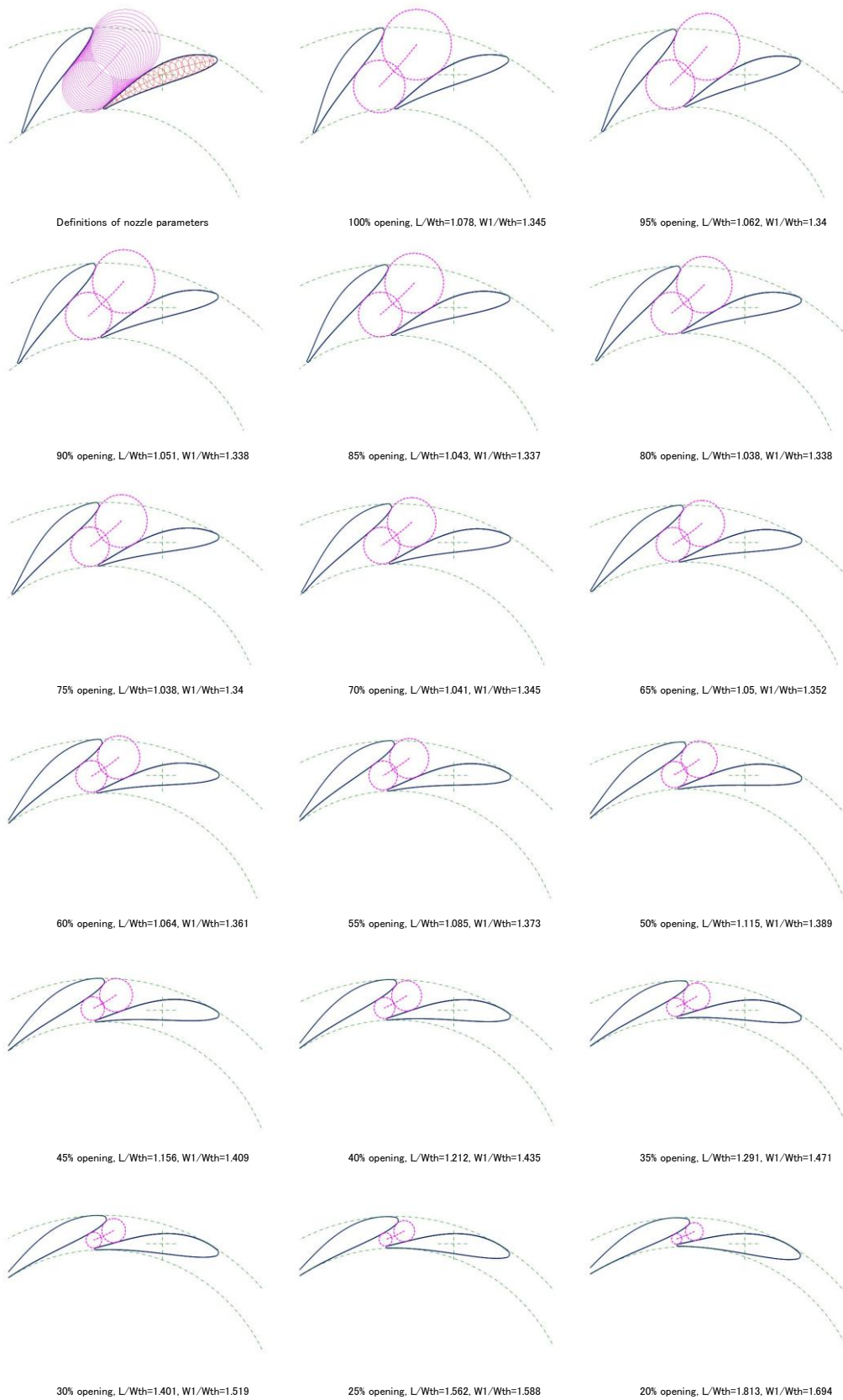
図 2-2-5. ノズル#3 流路およびベーン形状 (100~20%開度)
