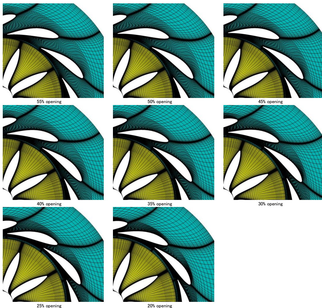
図 2-3-5b. ノズル#4 計算格子 (55～20%開度)
