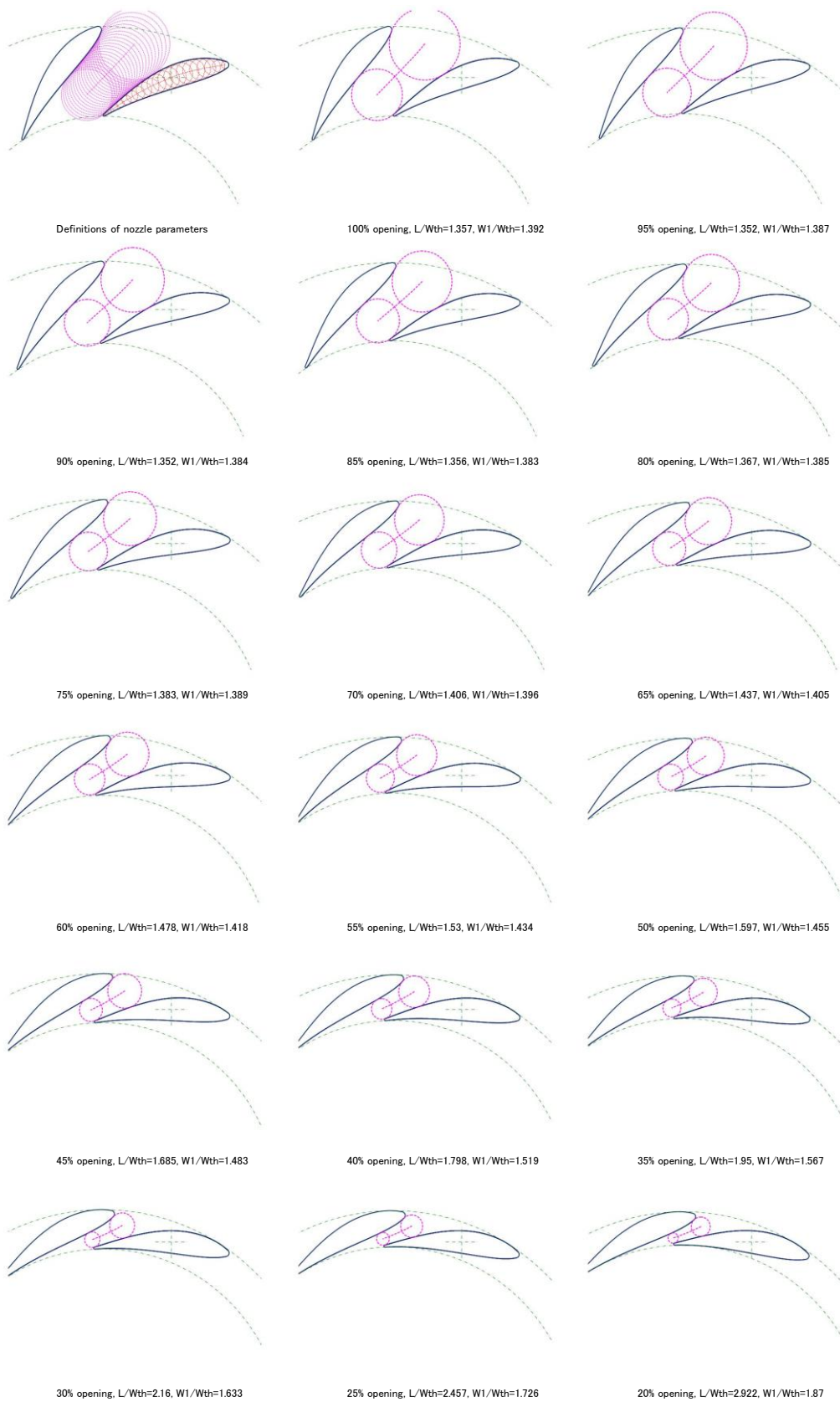
図 2-2-6. ノズル#4 流路およびベーン形状 (100~20%開度)
