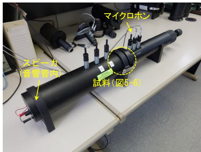
図 5-5 音響管試験の実施状況
