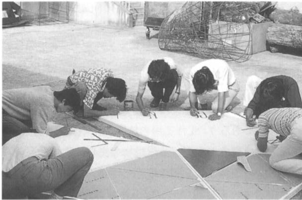
段ボールを素材にしたシェルターの外装パーツ
