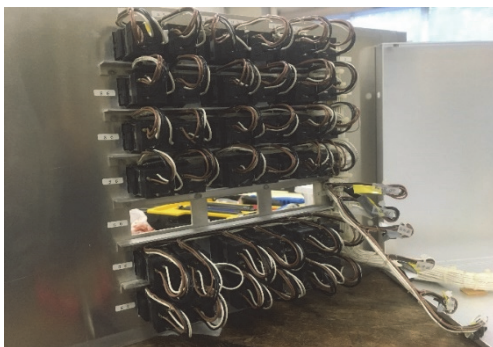
図 4 現場用昇降圧スイッチの内観
