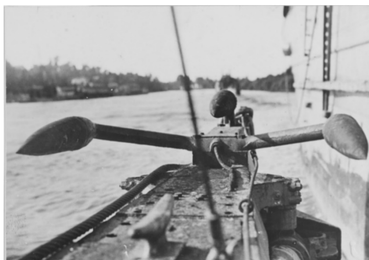
図 18. 複合型ハイドロフォンの一種 Y チューブ [海軍歴史センター提供: NH 52379]
