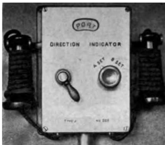
図7. ハイドロフォンの音を聞くのに用いられた受話器 [Fay 1912 より引用]
