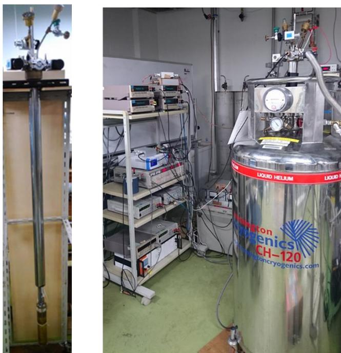
図 2.14 本実験で用いた極低温 needle-anvil 型実験装置の全体図。液体 He ベッセルに直接挿入して実験を行う。
