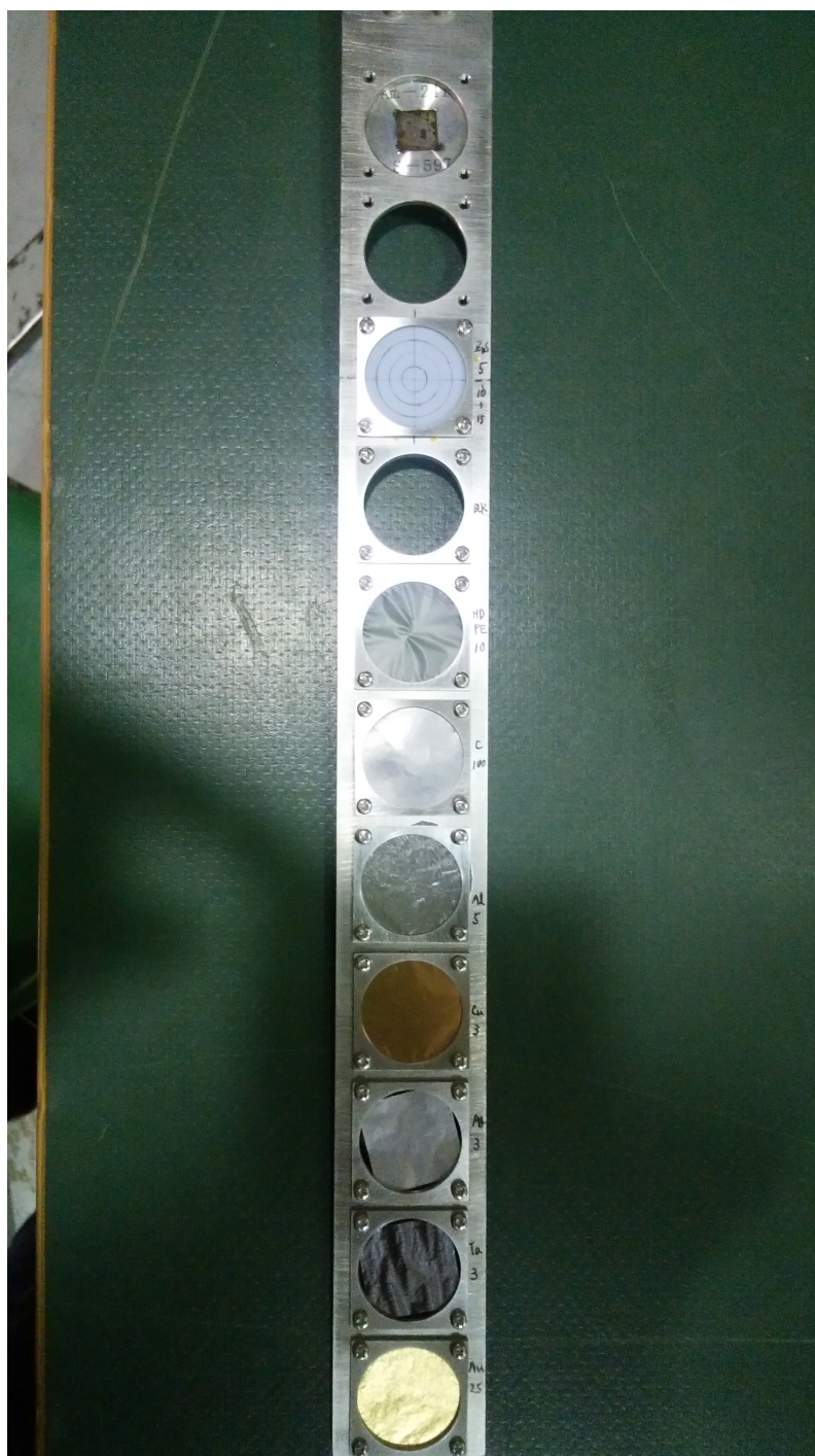
図 3.3 試料取り付け具にセットした標的試料, \alpha 線源, 蛍光板 (ZnS).
