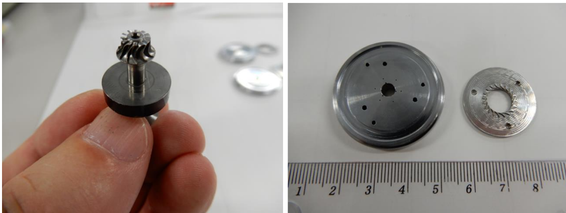
Fig.6.15 膨張タービン 試験後の分解写真（タービン側軸受）
