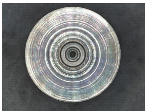
C側スラスト面の損傷の様子
