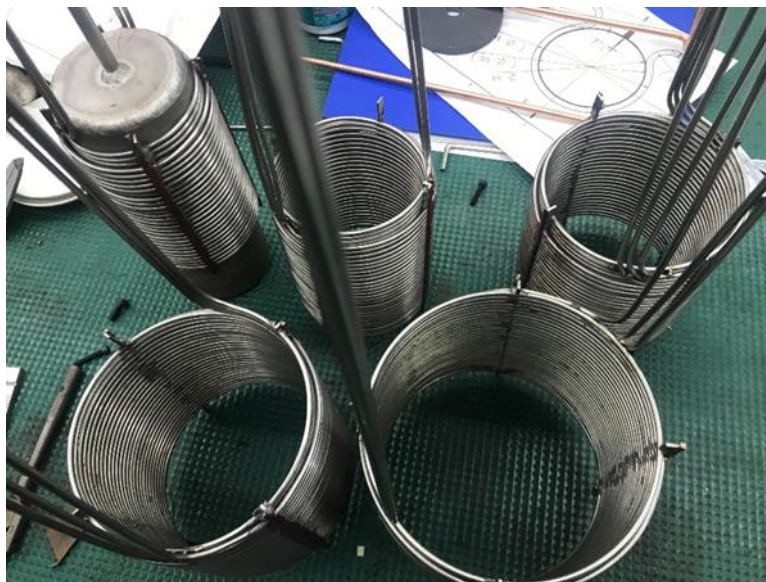
Fig. 5.19 厚肉伝熱管の各層コイル曲げ加工状況
