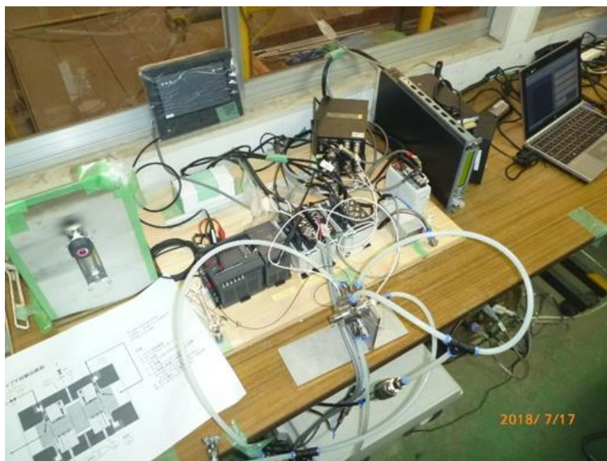
Fig. 5.14 膨張タービン機械回転試験 計測状況
