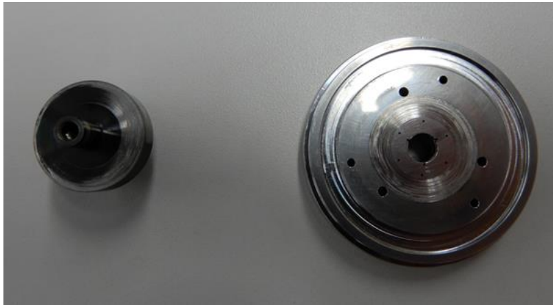
Fig.6.8 第1回試験による回転軸とスラスト軸受の接触損傷の様子(膨張タービン側)
