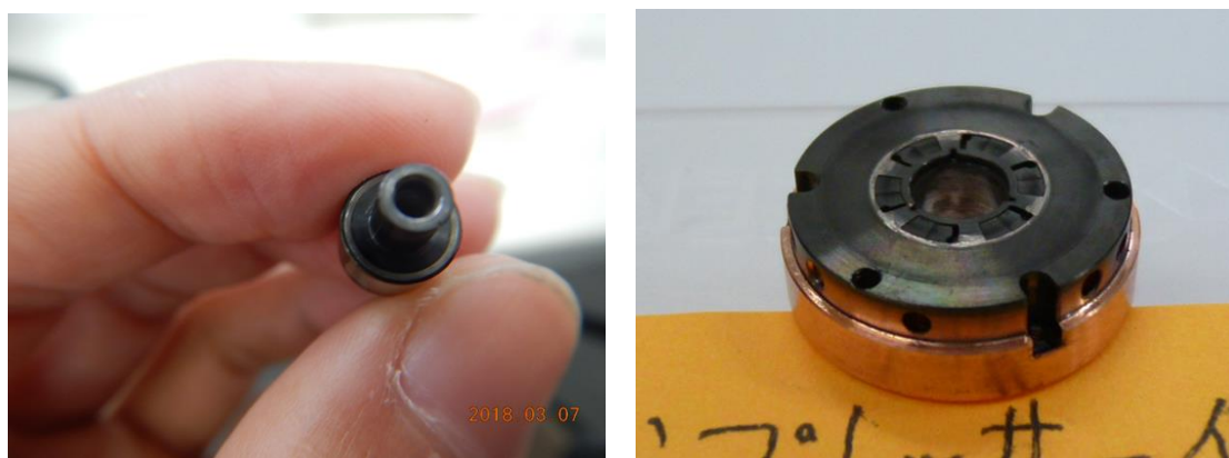
Fig.5.7 スラスト軸受面の接触事例(プロトタイプⅢ)
