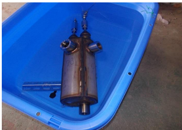
Fig.5.21 アフタークーラーの耐圧試験（試験圧力：150MPa(G)）
