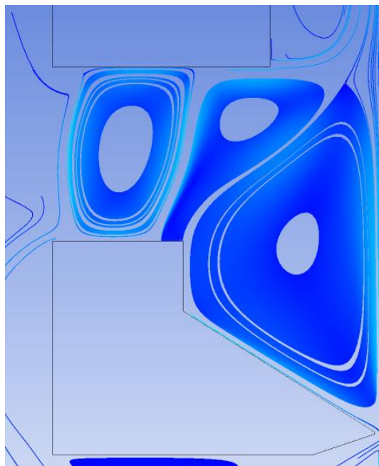
Fig.4.26 下部パージジェット流線( p_p = 5\text{kPa} )
