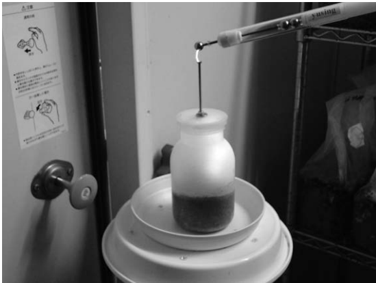
Fig. 4 Pulsed power stimulation treatment. 図4 電気パルス印加による刺激処理
