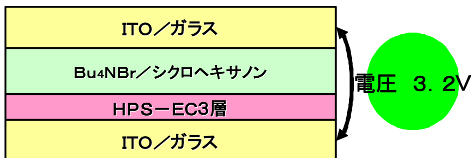
図4-11 エレクトロクロミック素子構造
