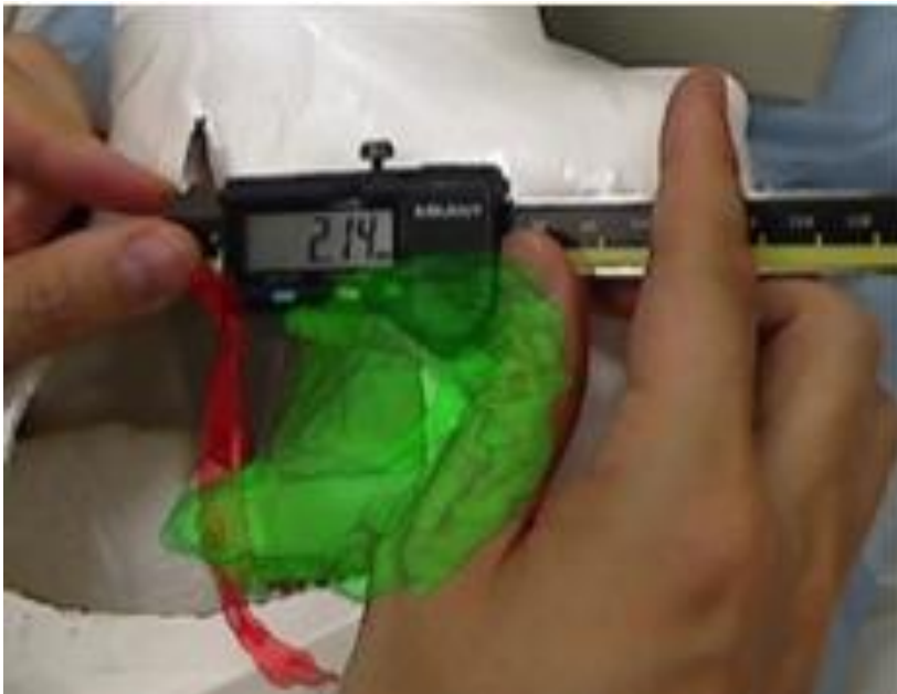
図5 模型での検証において重畳誤差をデジタルノギスで計測しているところ
