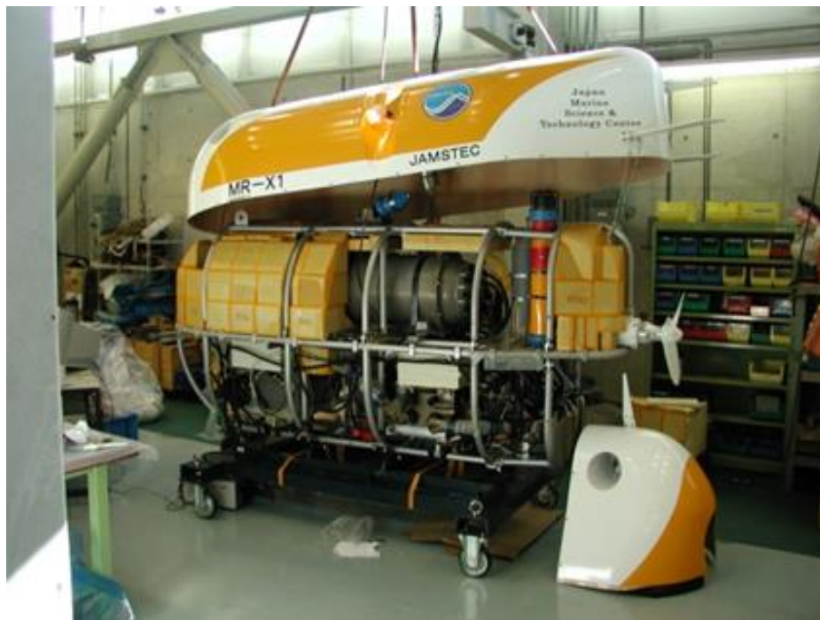
Fig1.1 自律型無人探査機 MR-X1 (出典：JAMSTEC)
