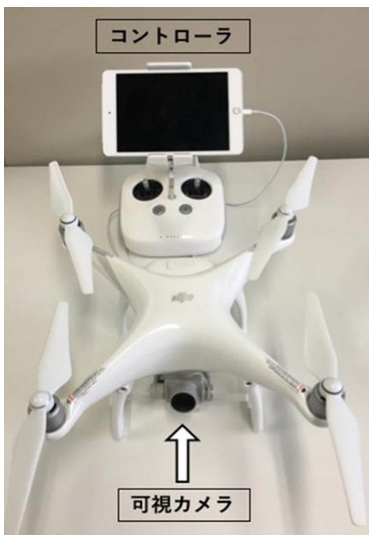
図 2.1 本研究で使用したドローン DJI 社製 Phantom4 Pro
