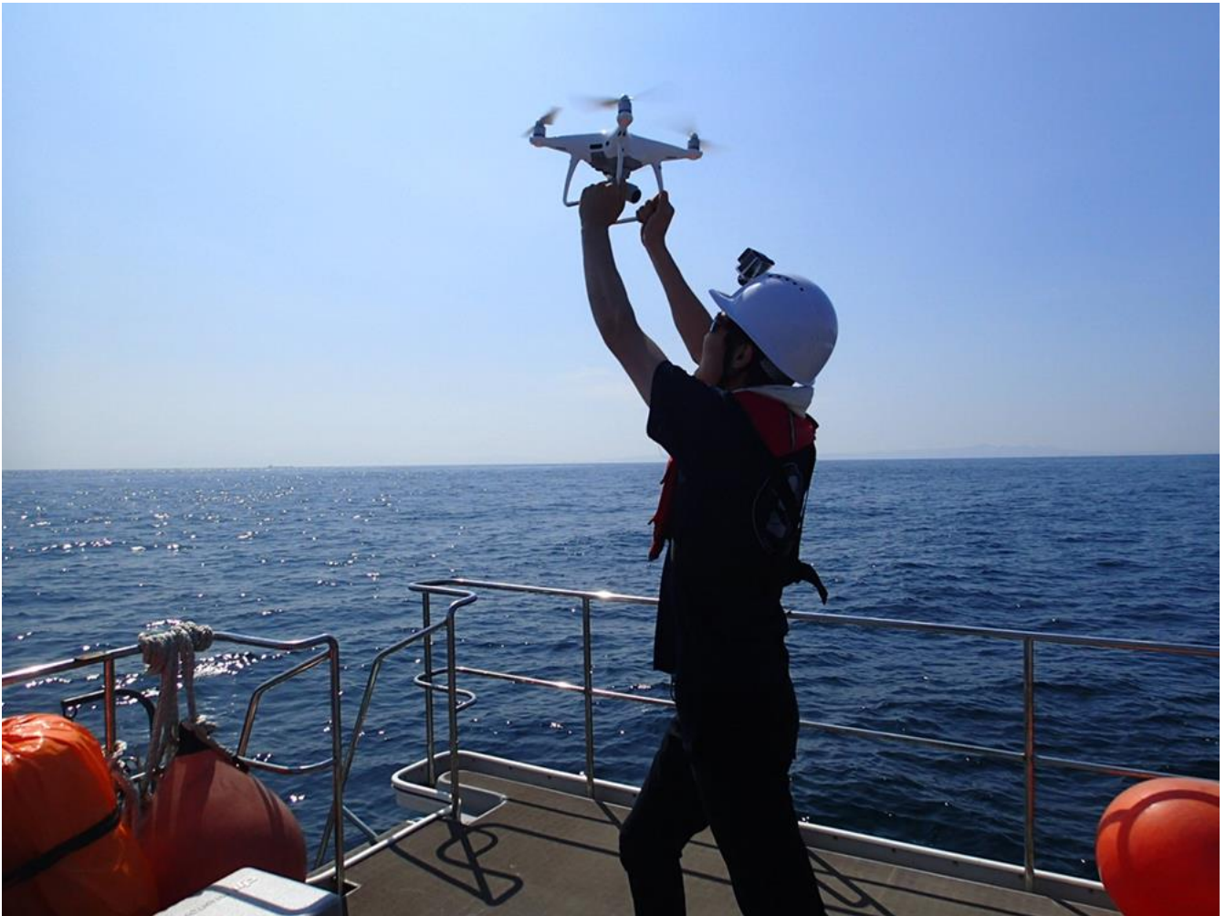
図 2.4 ドローン離着陸方法
