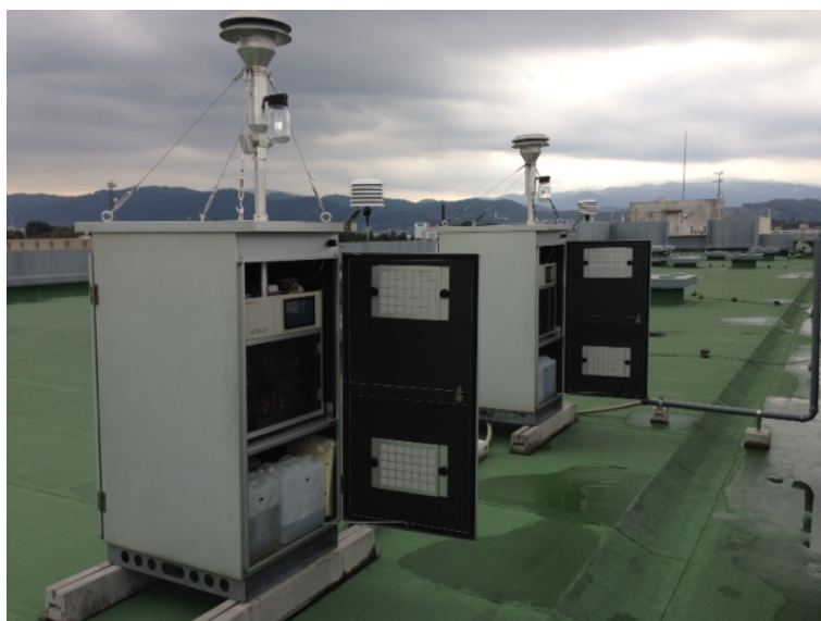
Fig.2.1 応用力学研究所屋上に設置した大気エアロゾル化学成分連続自動分析装置
