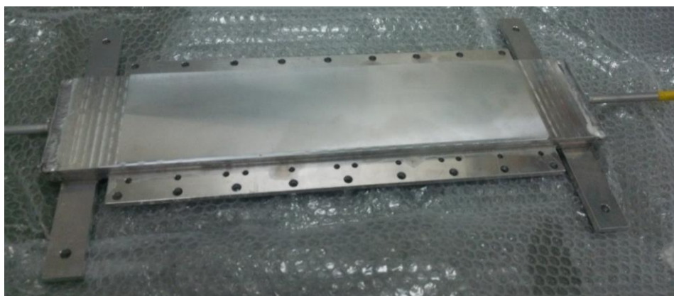
Fig.2.8 テストセクション冷却水流路写真(両面冷却方式)
