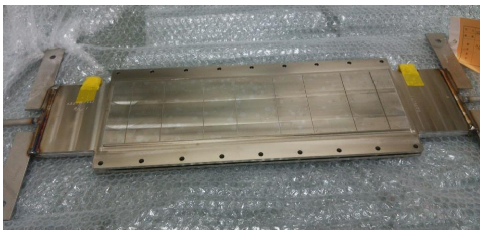
Fig.2.7 テストセクション冷媒流路写真(両面冷却方式)
