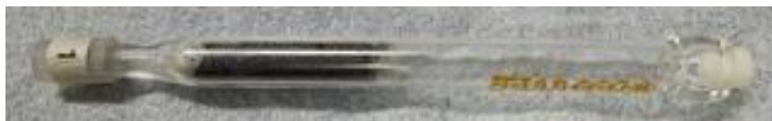
図 3.11 Tenax GR(捕集管)
