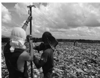
図4 インドネシアタマカハ処分場におけるメタン濃度計測
