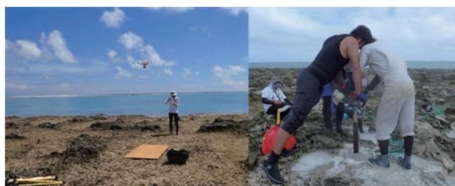
久米島でのフィールドワークショップの様子(左はドローンを用いた写真測量, 右は離水サンゴ礁の岩石コア採取)
