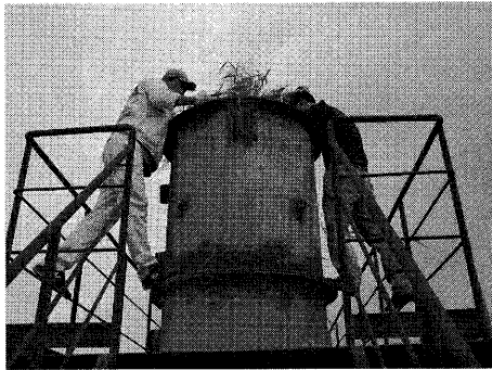
図2 上海市老港廃棄物処分場に設置したライシメータ
