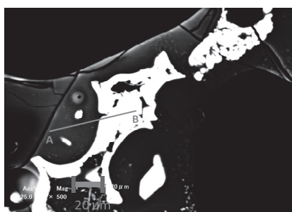
図4 焼却灰薄片試料の SEM 画像
