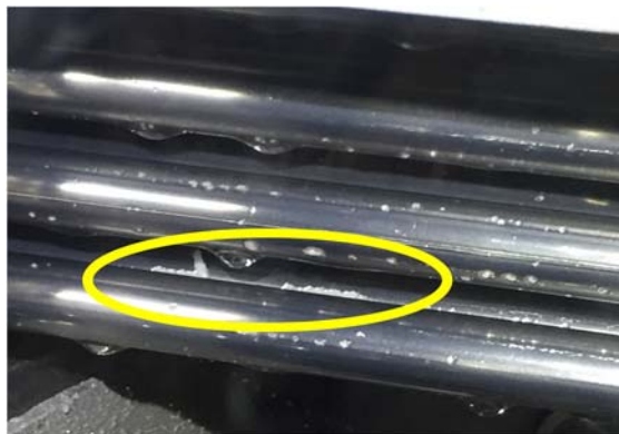
図 2-4 伝熱管写真－濃い液(テスト後)
