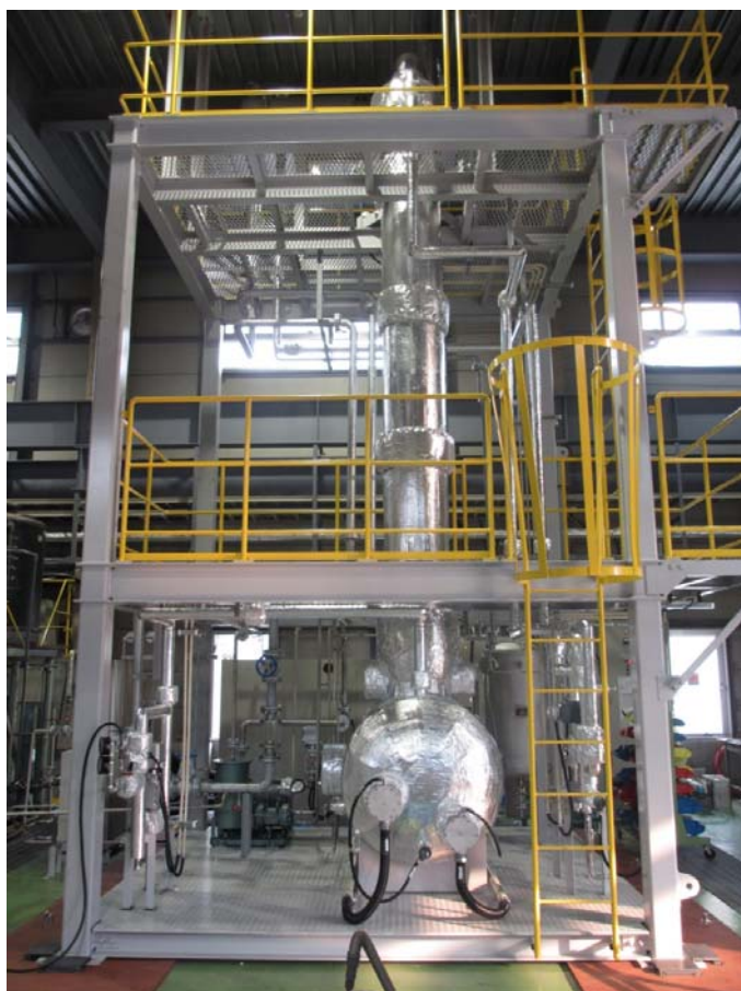
図 3-6 スケールアップした蒸留試験装置
