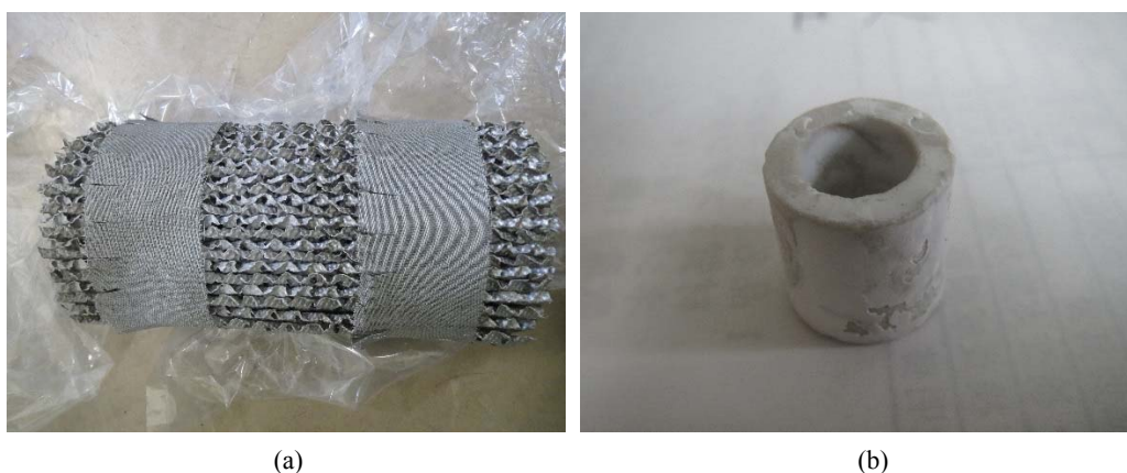
図 4-2 (a) 規則充填物(Sulzer-750Y) (b) ゼオライトで被覆したラシヒリング(φ13)
