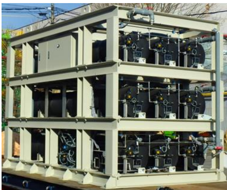
図 5.19 1000 Nm 3 級水素吸蔵合金タンクシステムの外観
