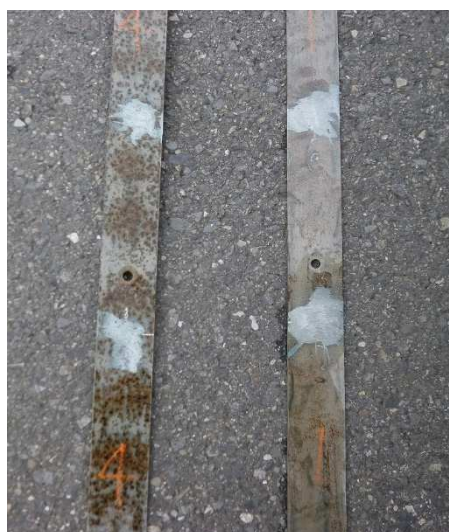
写真-3.3 電気防食した鋼材と無防食の鋼材の素地面調整した鋼材表面状況
