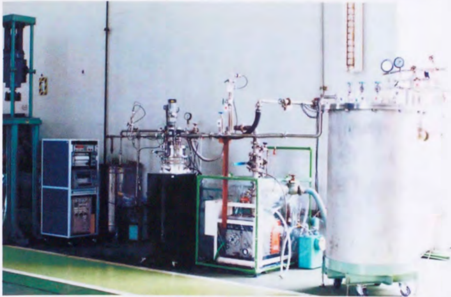
計測装置 ガラス製デュワー 真空ポンプ 極低温 He 発生装置 装置全景
