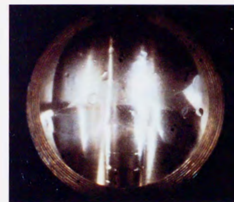
写真-2.3.1 液体CO 2 の密度変化 (科学朝日, 1990) (圧力 50 kg/cm 2 、水温 11 °C)
