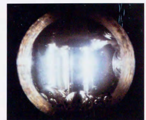
写真-2.3.3 液体CO 2 の密度変化 (科学朝日, 1990) (圧力 390 kg/cm 2 、水温 11 °C)
