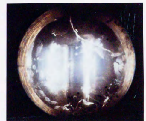
写真-2.3.4 液体CO 2 の密度変化 (科学朝日, 1990) (圧力 390 kg/cm 2 、水温 2 °C)
