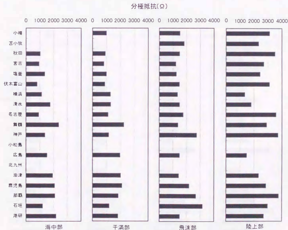
図-4.6 分極抵抗の計測結果 (暴露2年)
