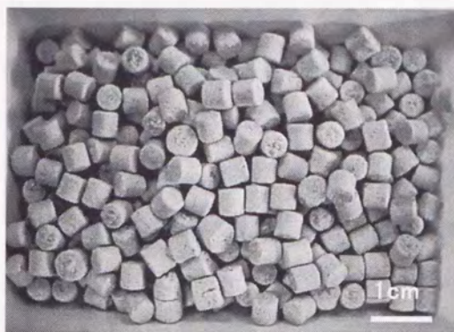
図 5-8 超淡口醤油製造用バイオリアクター担体として用いられていた多孔質アルミナ
